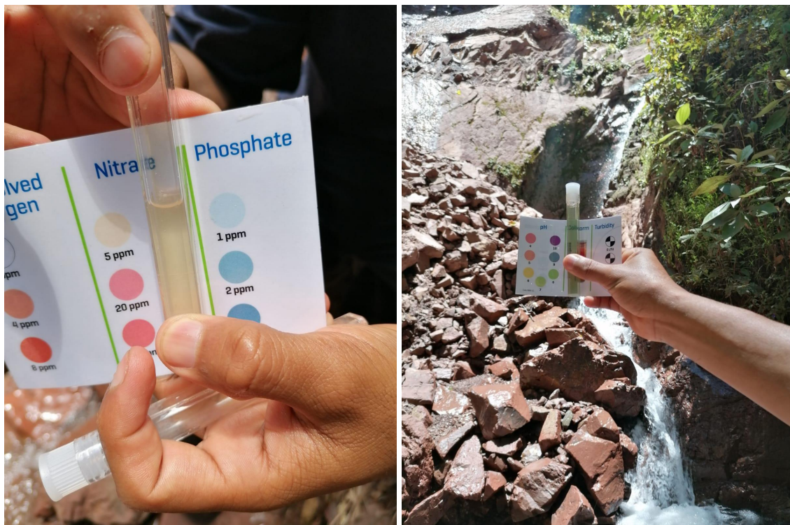
Figura 4. Detalle de los resultados obtenidos de los niveles de nitrato y pH mediante métodos colorimétricos.
